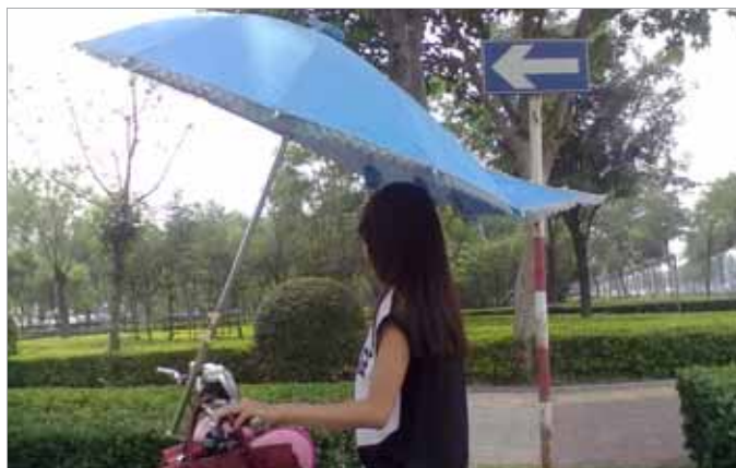
在电动车上安装遮阳伞,存在安全隐患。
