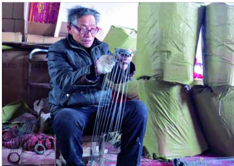
第一步:组架,把灯笼骨架拼接起来。
