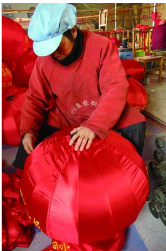
第五步:套布,将灯笼布套在骨架上,灯笼就初步成型了。
