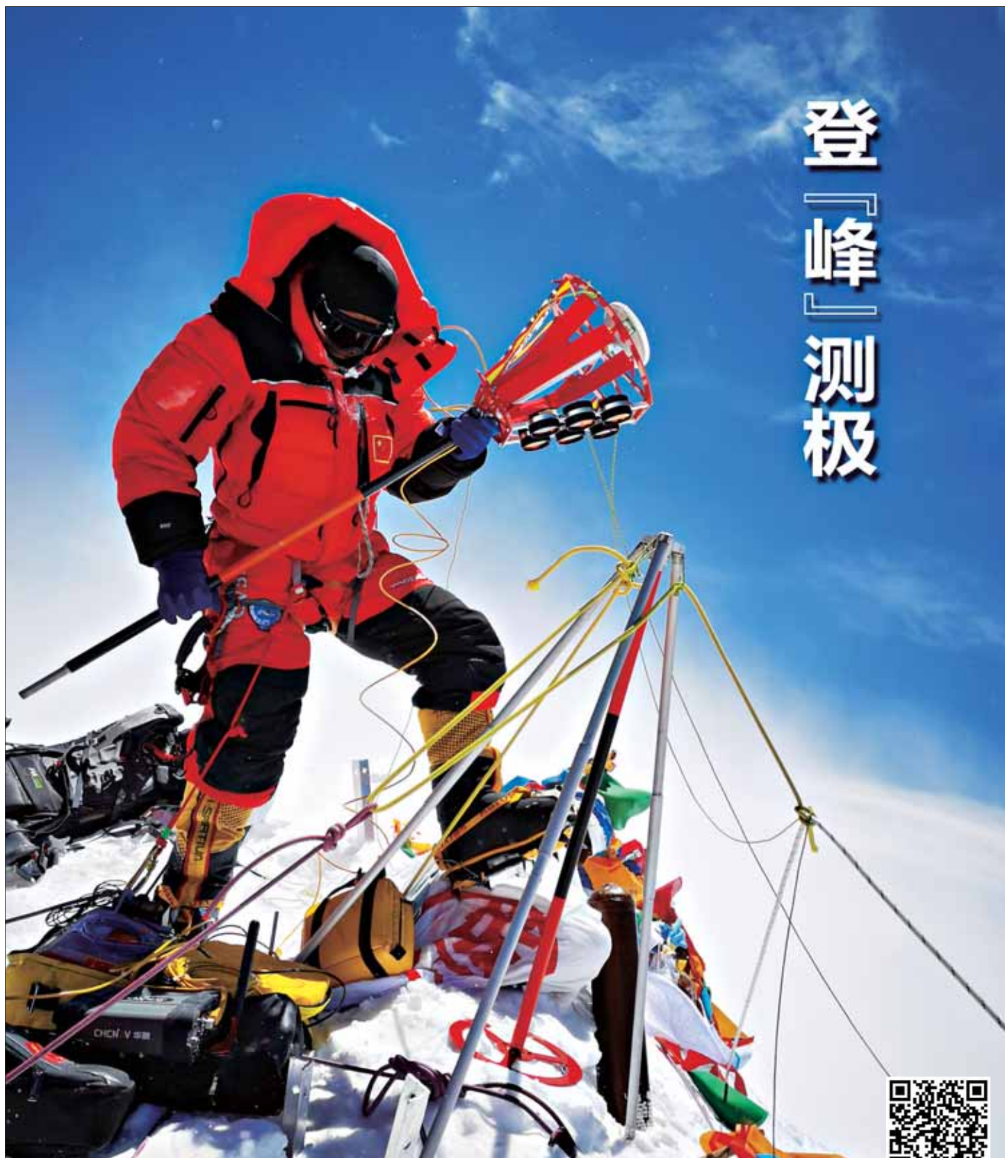
5月27日,2020珠峰高程测量登山队成功登顶世界第一高峰珠穆朗玛峰。他们将在峰顶竖立觇(chān)标,安装GNSS天线,开展各项峰顶测量工作。45年前的今天,中国人首次将觇标带至珠峰峰顶。 新华社特约记者 边巴 摄
