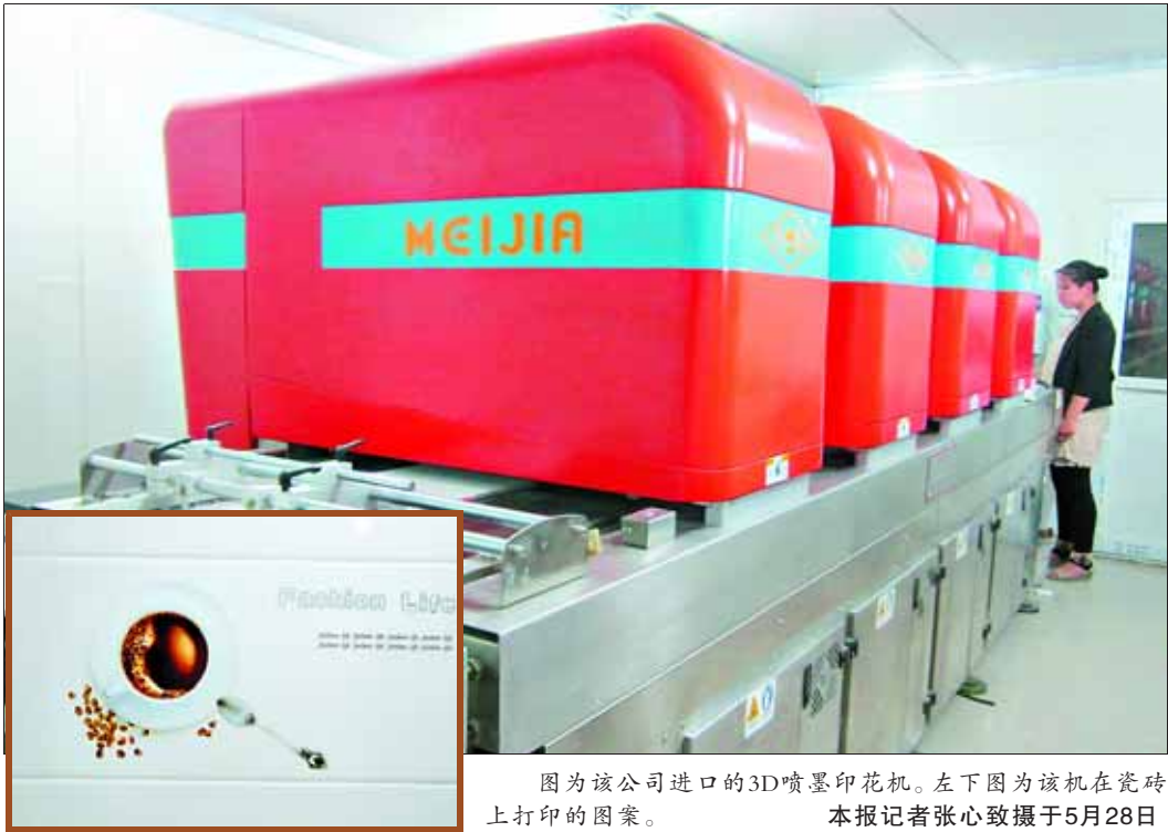
图为该公司进口的3D喷墨印花机。左下图为该机在瓷砖上打印的图案。
