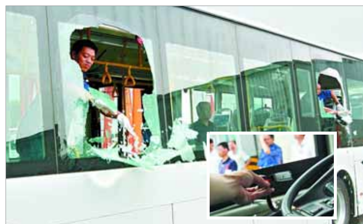
据了解,厦门将对全市BRT车辆(快速公交)安装自动爆破器,以提高车辆安全性能。大图为6月11日,工作人员演示车辆自动爆破器的使用效果。小图为安装在车辆驾驶座上的自动爆破器按钮。
