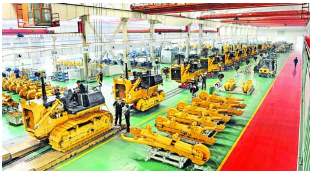
山推股份推土机组装生产线。
