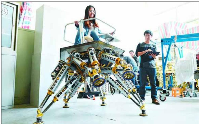
10月28日,由上海交通大学研发的具有自主知识产权的“六爪章鱼”救援机器人亮相。“六爪章鱼”机器人高约1米,由18个电机驱动,通过远程遥控使用,能够灵活地沿各个方向稳定行走,速度可达1.2千米/小时,负重达200公斤。据悉,“六爪章鱼”具备深入复杂危险环境的工作能力,可在化学污染、水下和火灾等环境下完成探测、搜索和救援等任务。新华社发(赖鑫琳 摄)
