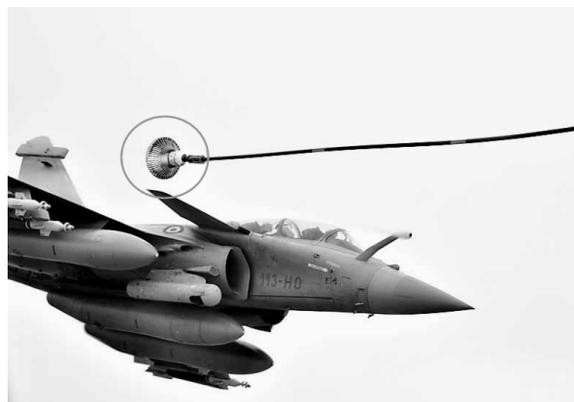
近日,美国媒体公布的一组空中加油照片中,揭露了一次发生在去年马利行动中事故。2013年3月17日,美军一架KC-135加油机在马里执行支援任务,为一架法国空军的阵风战斗机进行空中加油。不料在加油过程中这架阵风战斗机突然向左翻滚,导致加油接口(图中圆圈处)脱落,阵风战斗机的加油管接口也遭到损坏。(据《环球时报》)
