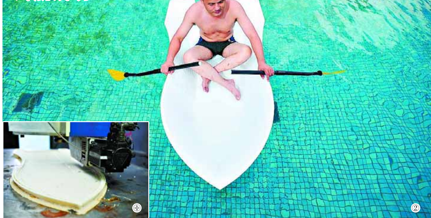
7月13日,三亚思海创机电工程设计有限公司研制的FDM型3D打印机成功制作出一艘小船,并下水试航成功。小船长2米,宽0.8米,高0.3米,重量35公斤,采用尼龙树脂材料,可搭乘两个成年人。据了解,这台3D打印机可打印6米长、4米宽、2米高的物品,是目前国内最大的3D打印机。图①为3D打印机正在制造小船。图②为技术人员乘坐3D打印机制造的小船试航。 新华社记者 郭程 摄
