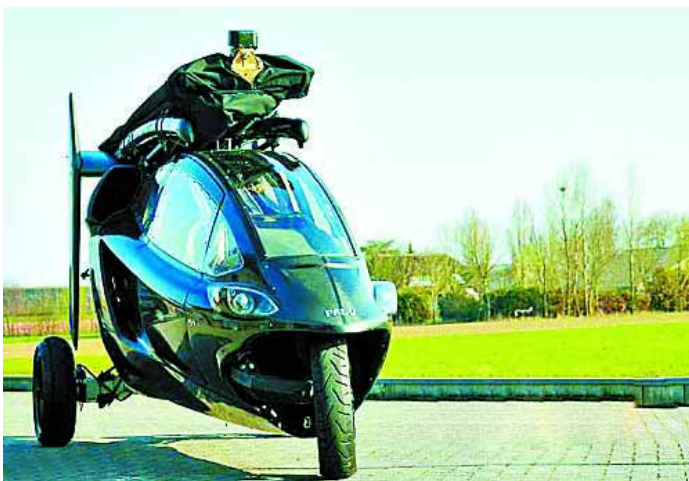
“Pal-VOne”飞行摩托可在10分钟内从摩托车变身为旋翼机。
