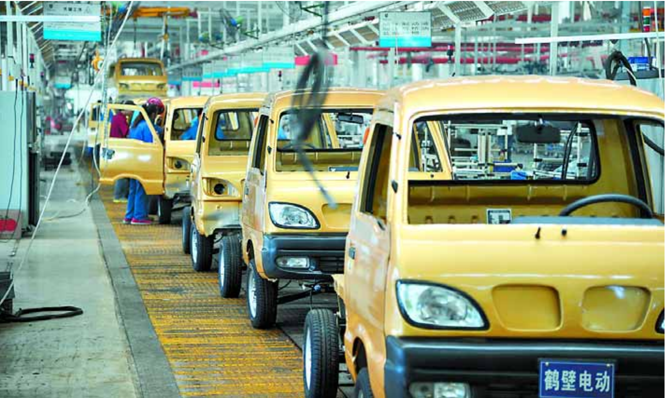
8月25日,华晨汽车(鹤壁)天马股份有限公司总装车间内,技术人员正在加紧组装鹤立牌电动货车。据介绍,该公司满负荷运转每天可生产100辆电动货车,货车时速可达40公里,一次充满电可行驶120公里,载重500公斤,适合城乡居民使用。
