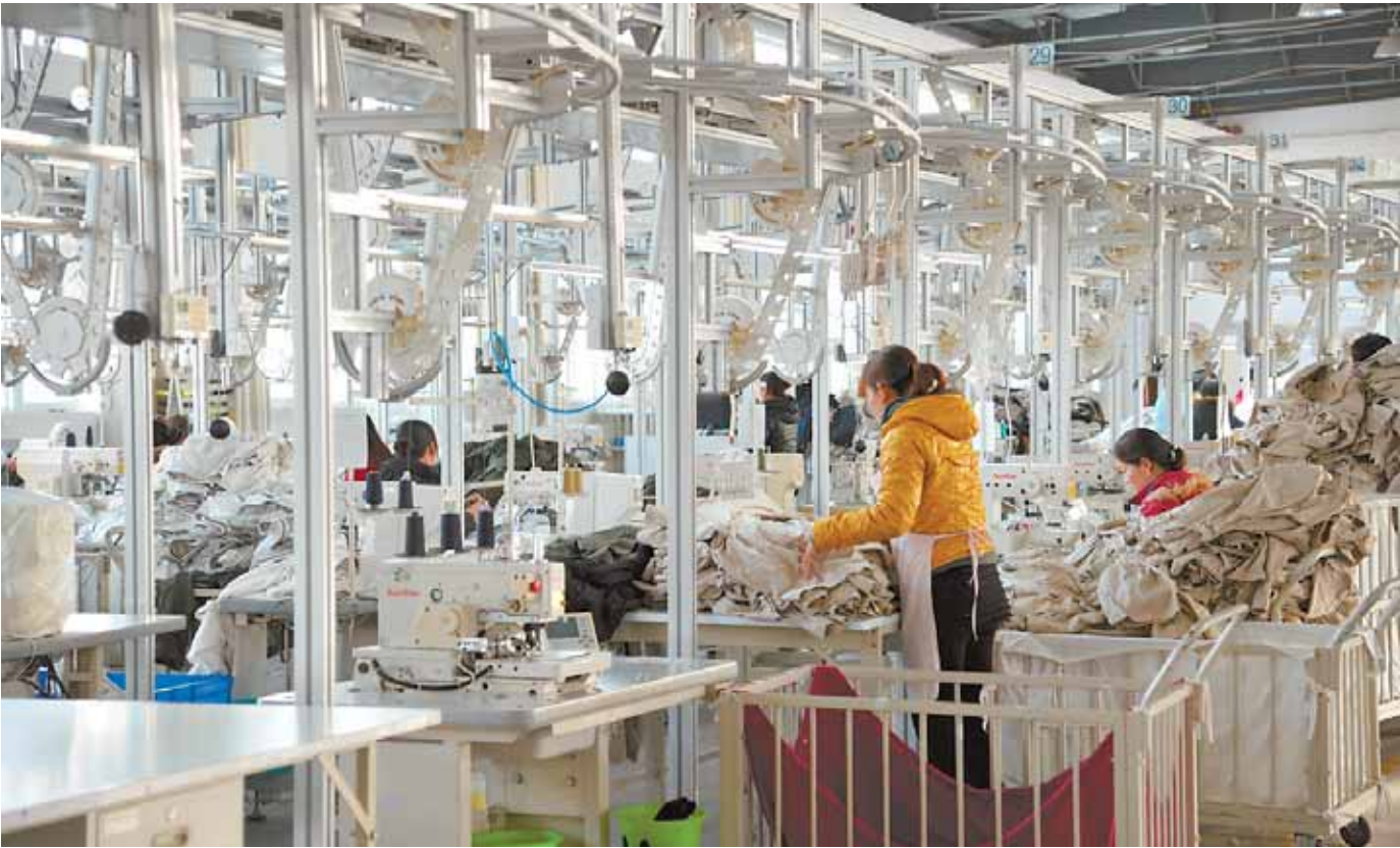
12月2日,河南万家欢乐纺织服装有限公司生产车间内,技术工人正在运用该公司与新加坡双星集团共同研发的“衣拿”智能服装生产吊挂系统生产服装。
