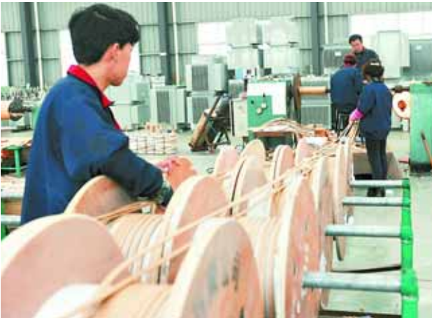
河南省大华电力设备制造有限公司位于金山工业园区，主要生产变压器、箱式变电站和高低压配电柜等电力设备。公司年产变压器680台，高压配电柜约300面，低压配电柜约1000面。图为12月3日工人在车间为变压器绕低压线圈。
