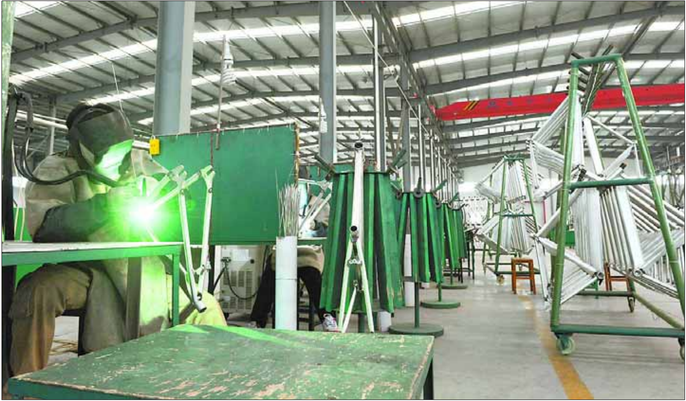
河南捷美特镁科技有限公司位于金山工业园区，该公司去年10月投产，主要生产镁合金自行车架、电动车车架，产品销往天津、深圳等城市。图为12月2日工人在生产车间焊接车架。
