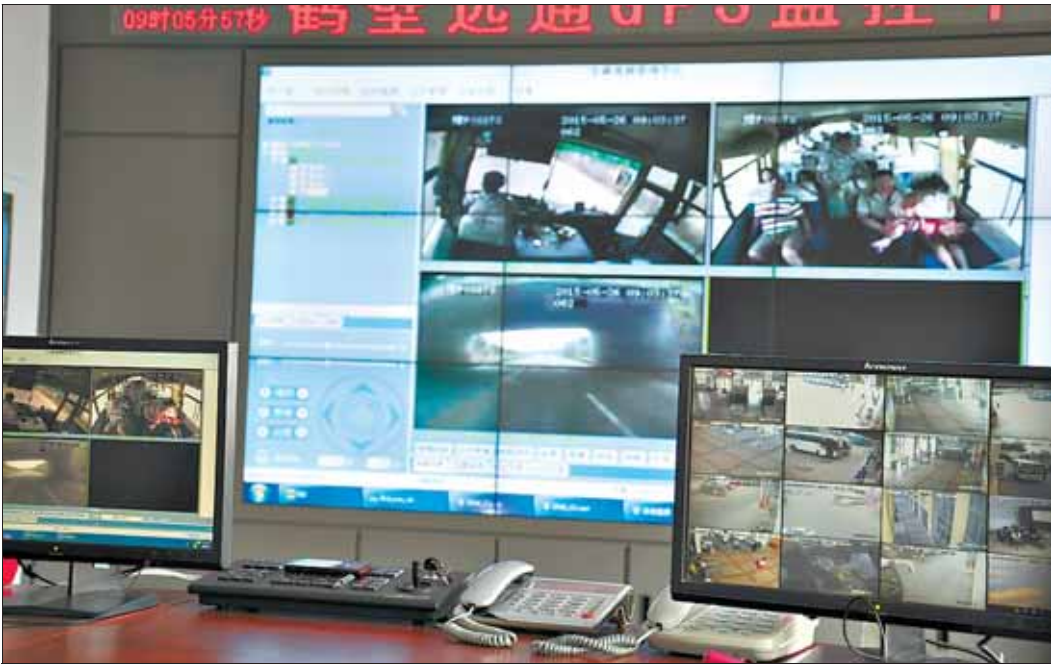
图为淇滨客运总站智能调度监控中心的车载视频监控系統
