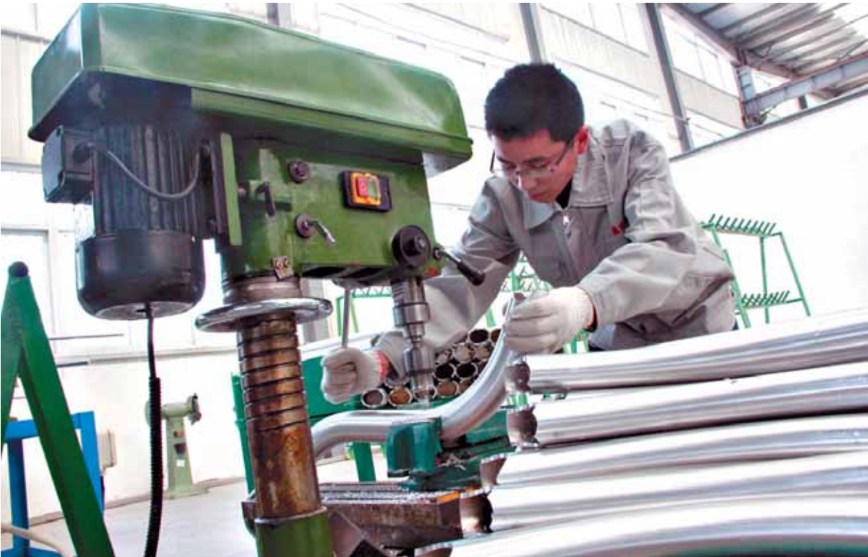
捷美特公司生产车间内,技术人员操作机器在镁合金管材上冲孔。
