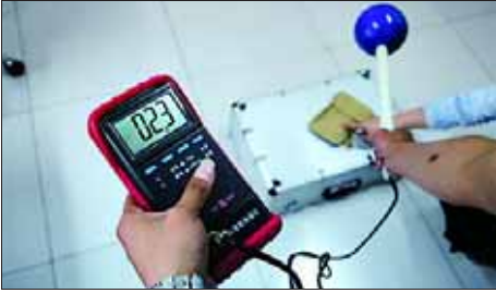
实验人员用全向智能场强仪测试卡包内射频发射器的电场。
