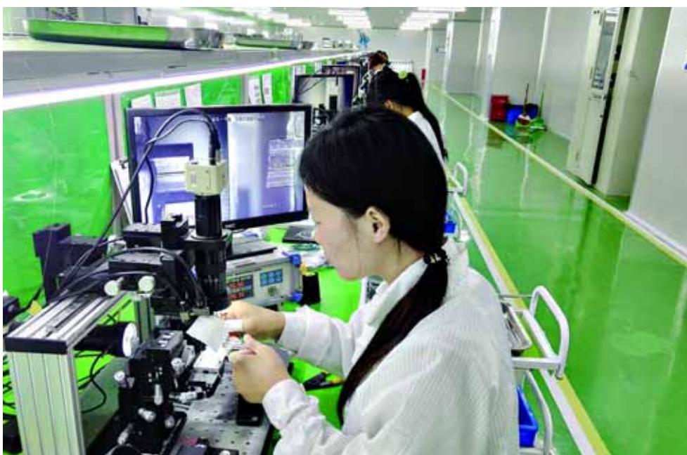
5月20日，在位于金山产业集聚区的河南标迪通信技术有限公司芯片封装车间，工人正在将光纤与芯片进行耦合。该公司以仕佳光子生产的PLC型光分路器芯片为原件，封装生产光分路器等产品，主要供给国内三大电信运营商及华为、烽火通信和中天科技等。
