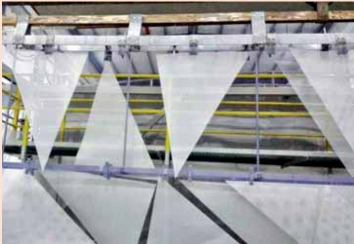
为使反射面面板长期耐腐蚀，须在表面镀一层厚度不小于15微米（1毫米=1000微米）的阳极氧化膜，而一般镀膜厚度仅为4微米。经过技术攻关，海能达鹤壁公司镀膜厚度可达18微米，达到国际顶尖精准程度。这种面板使用寿命可达百年。图为海能达鹤壁公司双氧化槽全自动阳极氧化膜镀膜生产线。
