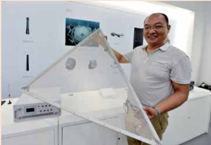
反射面面板为铝镁合金制成，厚度只有1毫米，上面布满直径5毫米小孔。每块面板运到现场后要保证平面挠度（变形程度）小于1.5毫米，这给面板冲切、氧化、铆接、运输带来很大难度。数量达上百万的反射面单元构件在加工、安装过程中还要能一一识别出来，这需要在每个构件上做好标识。
