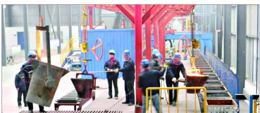
7月14日,在欧迪艾公司铸造车间,工人在铸造重型卡车支架。
