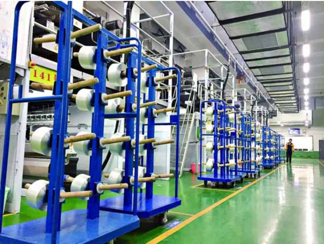
图为中维化纤锦纶66工业丝项目纺丝车间的牵伸卷绕设备。
