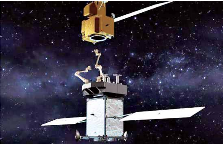
美国航天局研发的卫星在轨加注机器示意图
