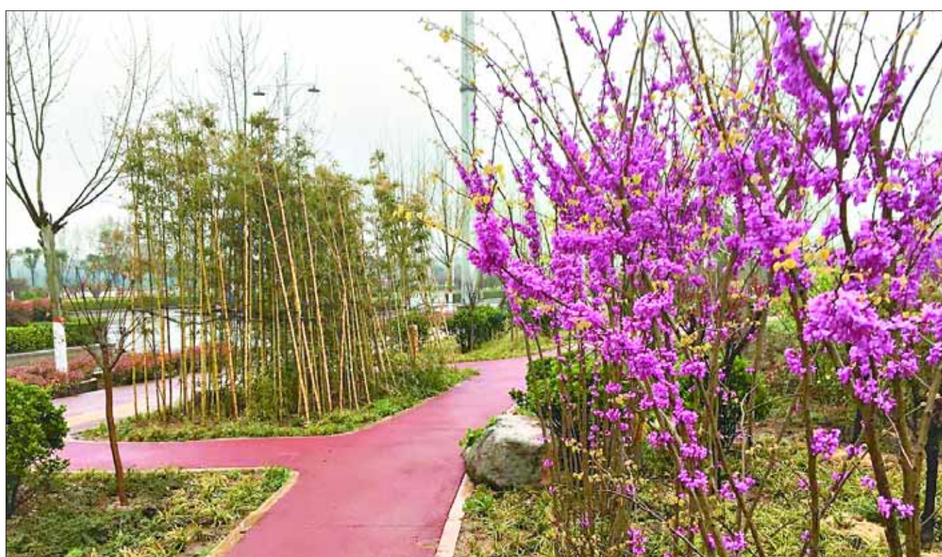
护城河健身步道因铺设了红色透水混凝土，透水性大大提高。
