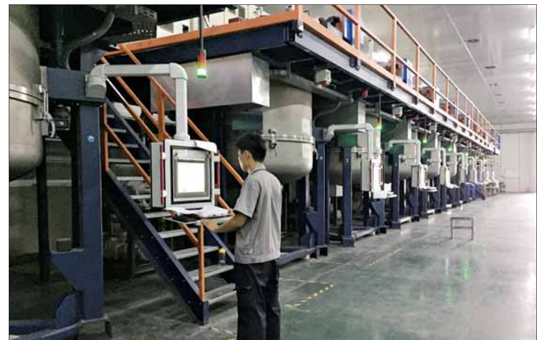
河南欧斯滕光伏电力发展有限公司的生产车间内，工作人员在操控铸锭炉。 本报记者 陈静 摄
