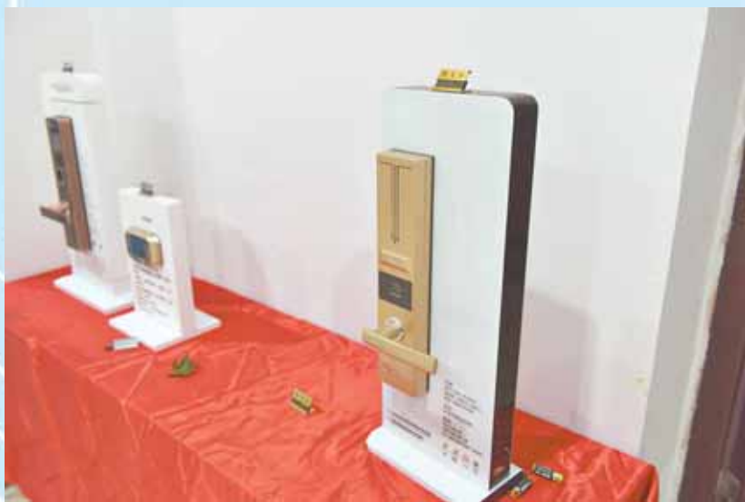
鹤壁高新区邱芬德科技有限公司研发的集指纹、密码、刷卡于一体的智能锁。
