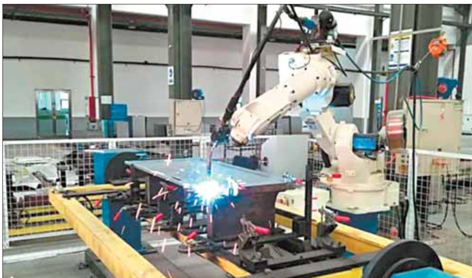
海能达公司机器人自动焊接机柜系统正在焊接产品。
