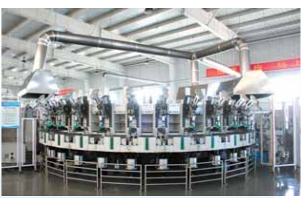
鹤壁飞鹤股份有限公司德国德仕玛自动化安全鞋生产线。
