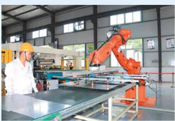
顺卿激光焊接科技(上海)有限公司的机器人设备对钢板进行激光拼焊。
