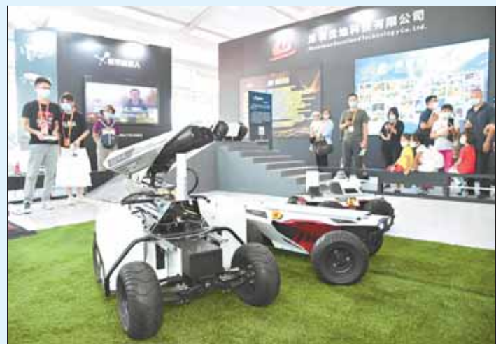
这是9月7日在服贸会服务机器人专题展区拍摄的消毒机器人。它适用于室内外大规模消毒作业,可远程驾驶控制。 新华社记者 任超 摄
