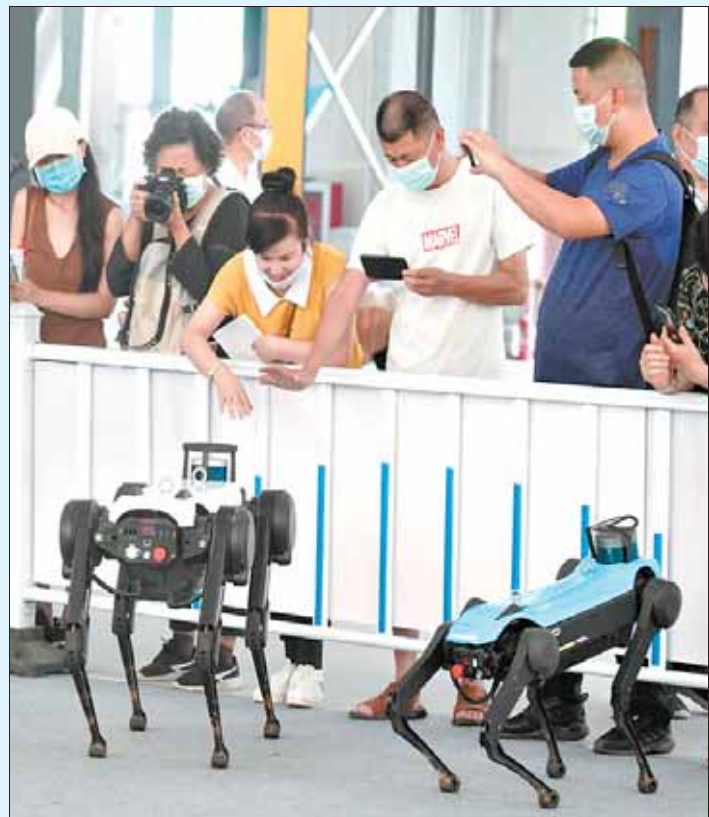
9月7日,在服贸会服务机器人专题展区,观众与“绝影”系列智能四足机器人互动。这款机器人具有较强环境适应能力、动态平衡能力和环境感知能力,可代替人类进行作业,可应用于安防巡检、科研展示、勘测探索和公共救援等场景。 新华社记者 才扬 摄
