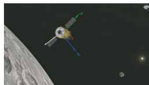
11月29日20时23分,嫦娥五号探测器在近月点再次制动,飞行轨道从椭圆环月轨道变为近圆形环月轨道。图为三维模拟动画图。新华社(北京航天飞行控制中心供图)
