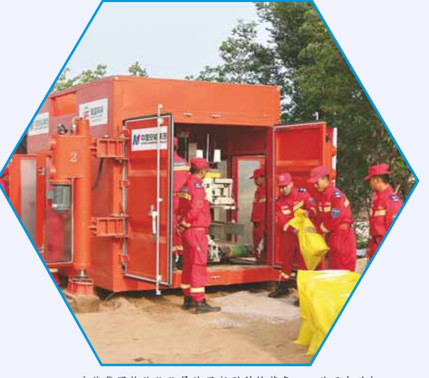
安能集团抢险队队员使用新型科技装备——砂石自动打包机打防汛沙袋。
