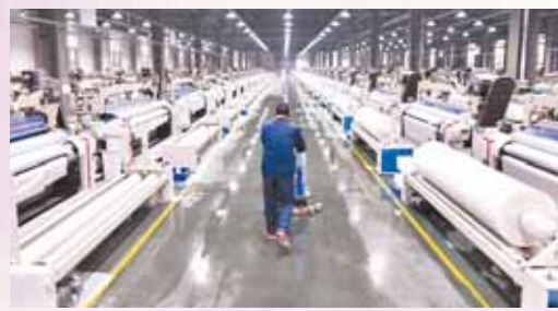
加快优势产业升级步伐。图为全国规模最大的风力发电脱模布生产基地——河南特种尼龙小镇工业园A区脱模布生产车间的喷水织机高速运转。
